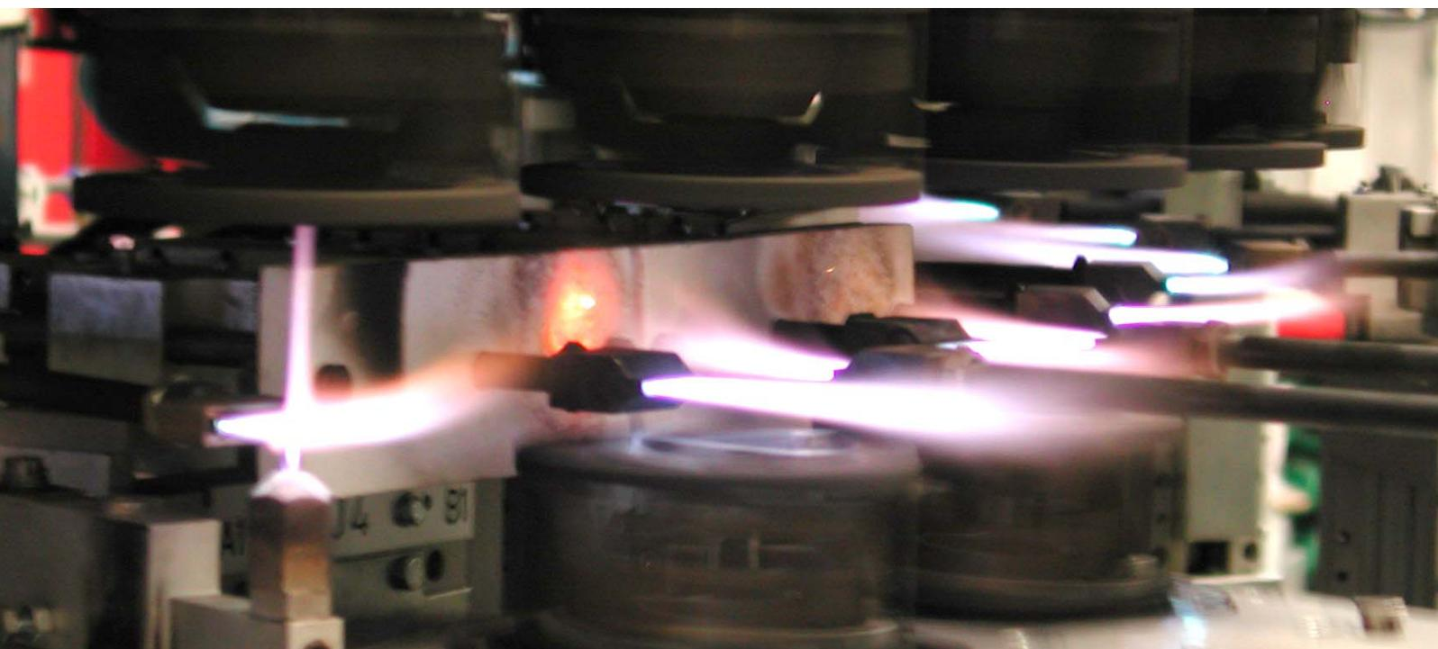
Macchina formatrice per la produzione di flaconi
